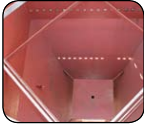
Surface Preparation: sandblast & primer
